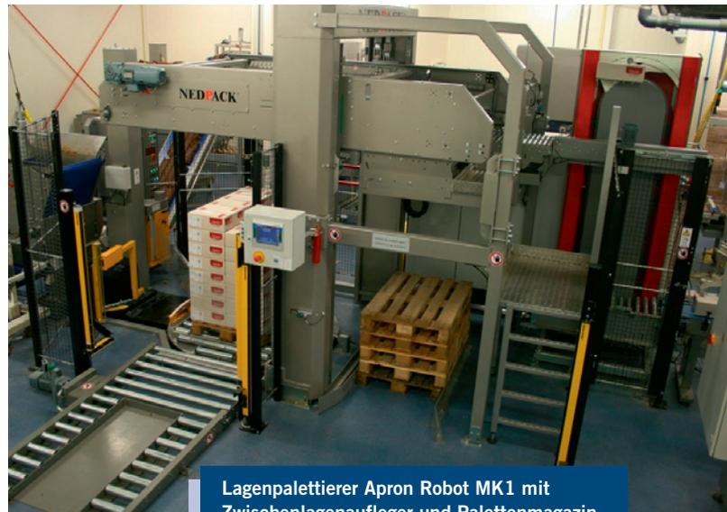
Lagenpalettierer Apron Robot MK1 mit Zwischenlagenaufleger und Palettenmagazin
